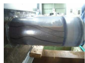
写真-12 閉塞状況
