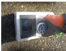
写真-5 鉄筋探査
